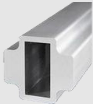
Traverso centrale in alluminio .Diametro 60 mm x 60mm. Spessore parete 5mm
